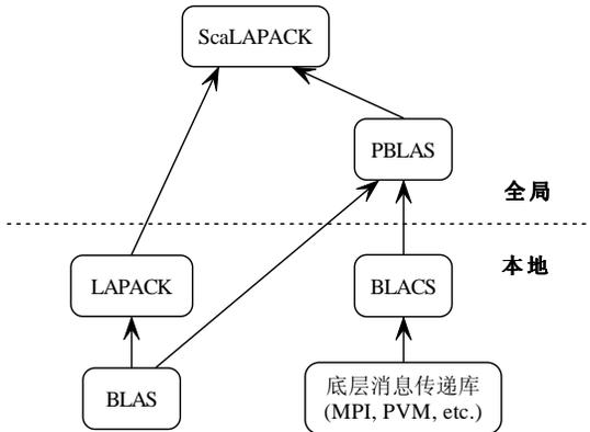
图 A.2 ScaLAPACK 软件的层次结构
